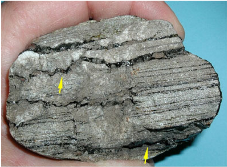
Abb.4. Schnitt durch ein Geröll aus dem Chiemgau-Kraterfeld mit offenen, glasgefüllten Rissen, die vermutlich durch schockinduzierte Spallation entstanden sind. Man beachte das "Fitting" der gezackten Bruchwände (Pfeile) als Beweis von Zugbrüchen.
