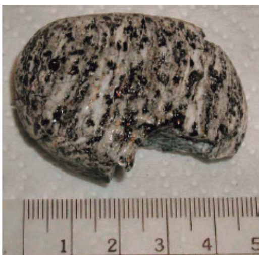
Abb. 5. Experimentell erzeugter "Glasstein" bei sehr kurzzeitiger Erhitzung auf ca. 2500 °C in einer Azetylenflamme.
