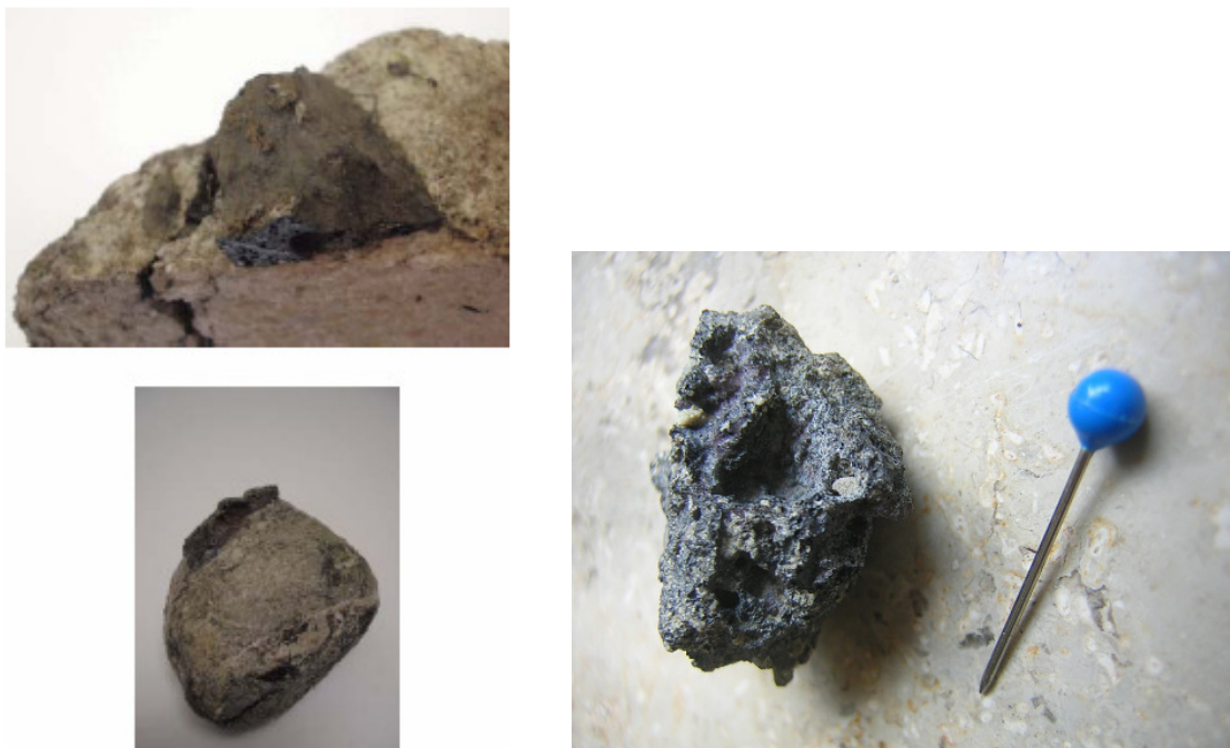
Abb. 6. Links: Schlackeartiges Gesteinsglas auf Geröllen der Krater 004 und 029. Rechts: schlackeartiges Glas vom Henbury-Meteoritenkraterfeld (Australien).
